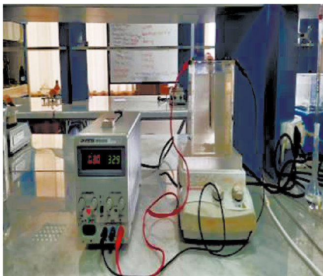
Рис. 1. Экспериментальная установка для изучения модельной системы: \text{Fe}-\text{K}_2\text{Cr}_2\text{O}_7-\text{NaCl}-\text{H}_2\text{SO}_4-\text{H}_2\text{O} и осуществления ЭК хромсодержащей сточной воды.
