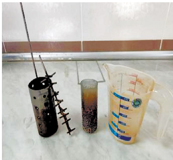
Рис. 1. Экспериментальная установка для изучения модельной системы: \text{Fe}-\text{K}_2\text{Cr}_2\text{O}_7-\text{NaCl}-\text{H}_2\text{SO}_4-\text{H}_2\text{O} и осуществления ЭК хромсодержащей сточной воды.
